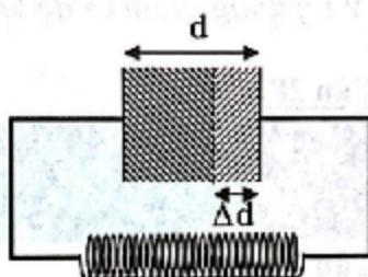
$$\text{ Dao động của mạch được duy trì khi } P_{CC} = P_{hp} \text{ hay: } \frac{U_0^2}{\pi\sqrt{LC}} (C' - C) = \frac{1}{2} U_0^2 \frac{C}{L} R$$
